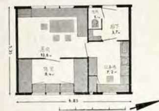
53 シエレ (獨逸) Cisle 諸般せる二世帯の住居。二階へは外部の鐵製階段で登る。小さな居室の増加に従つて居室を擴大する (第十 三圖参照)。浴所と便所の浴室とに於ける洗面器の配置。居室の二階に於ける小さな事務室は居室の擴大に 従つて大きくなる。乳母車や動物に適應しい設備を主眼の大き。(観察数 平常 2 最大限 2)
