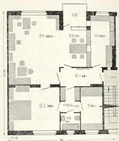
165 伯林 (獨逸) Berlin 床面積凡〇平方メートルから九一・二平方メートルに増加する場合四室平面の最も経済的なアポロシヨンの配置を示す 間。諸設備及び器具の配置は最も都合のよい形に基いてゐる。(観察数 平常 3 最大限 4)
